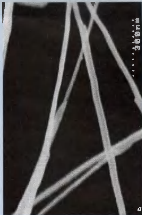
5 Рулон, в который удалось вставить хлорное железо, под растровым микроскопом: а — до реакции; б — после
