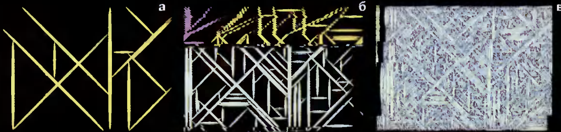
4 Этапы формирования мартенситной структуры в стали (по результатам численного моделирования): а - начальная стадия, б - промежуточная стадия, в - после завершения превращения
