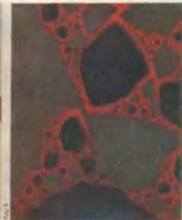
При температуре фазового перехода ферромагнетика (вблизи точки Кюри) появляются области порядка и беспорядка со сложными границами
