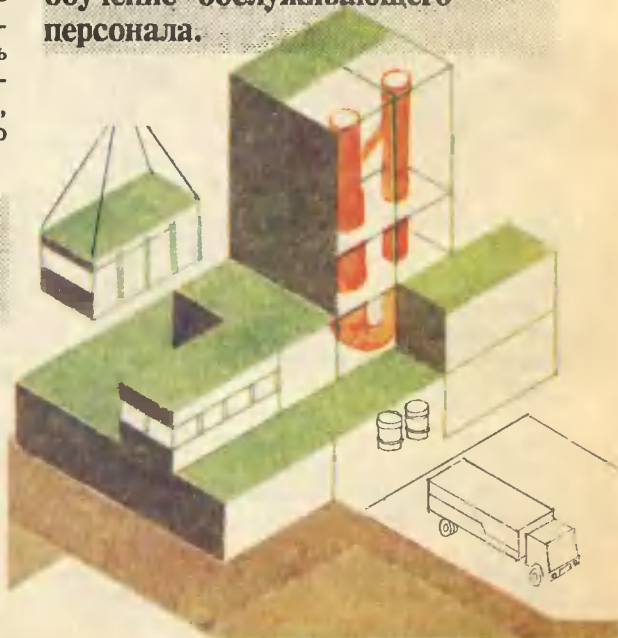
Промышленный модуль, выполненный из блоков, собирается за 1,5—2 месяца.
