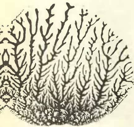
Фрагмент молекулы хлорсульфированного полиэтилена на стекле фотопластинки 6×9 см
