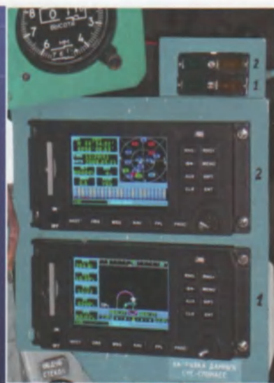
Размещение двух приемоиндикаторов СН-4312 в кабине штурмана Ил-76Д
