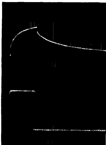
Рис. 228. Осциллограммы релаксации: а) фотопроводимости; б) тока короткого замыкания фотодиода. Длительность импульса \approx 150 мксек, T=77^\circ К.
