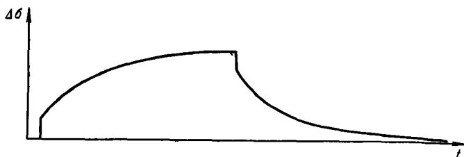
Рис. 78. Кривые релаксации при большой концентрации ловушек.
