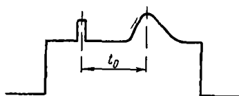
Рис. 170. Искажение формы сигнала из-за модуляции проводимости внутри «пакета».
