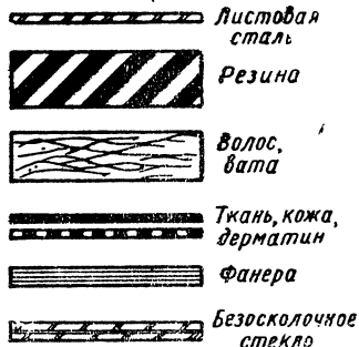
Фиг. 182. Виды штриховки, применяемой в чертежах кузовов в дополнение к стандартной.
