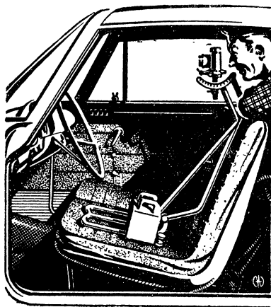
Фиг. 35. Прибор НАМИ для съемки панорам обзорности.
