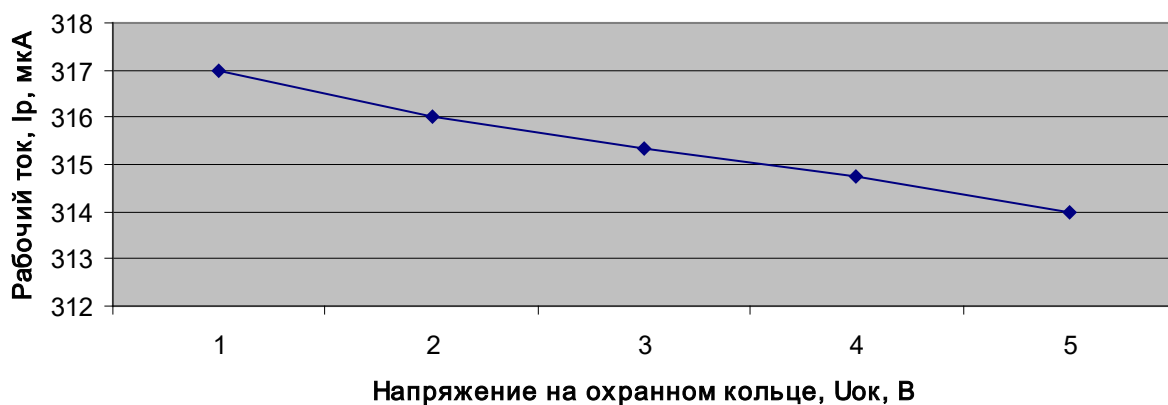
Рис. X3. Зависимость рабочего тока ( I_p ) от напряжения на охранном кольце ( U_{ок} ) [ U_{пит}=10В, U_z=5В, U_p=5В ]
