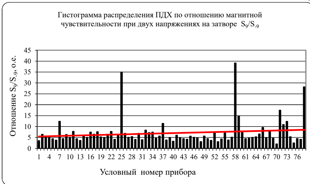
Рис. 13. Гистограмма распределения ПДХ по отношению магнитной чувствительности при двух напряжениях на затворе S_9/S_9
