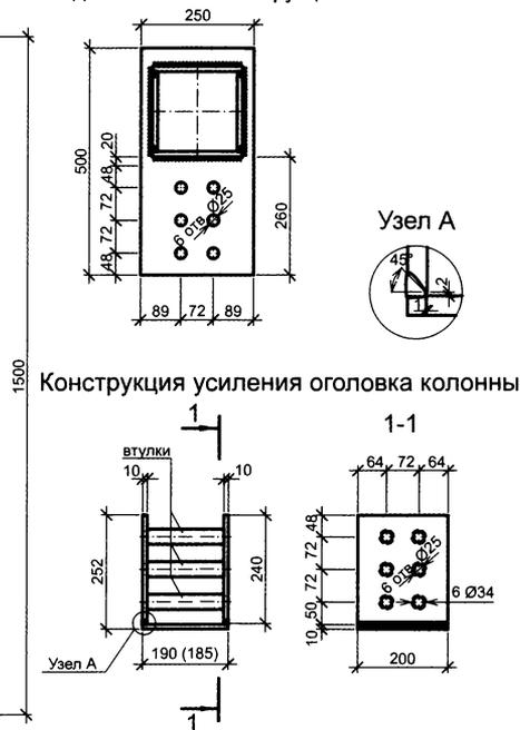
Конструкция усиления оголовка колонны
