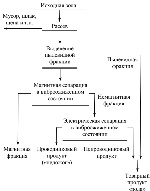
Рис.4. Принципиальная технологическая схема сухого обогащения золы уноса ТЭС в псевдоожиженном состоянии
