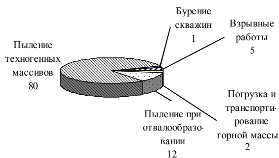
Рис. 2. Удельный вклад различных источников в выброс неорганической пыли при открытой разработке железорудных месторождений, %
