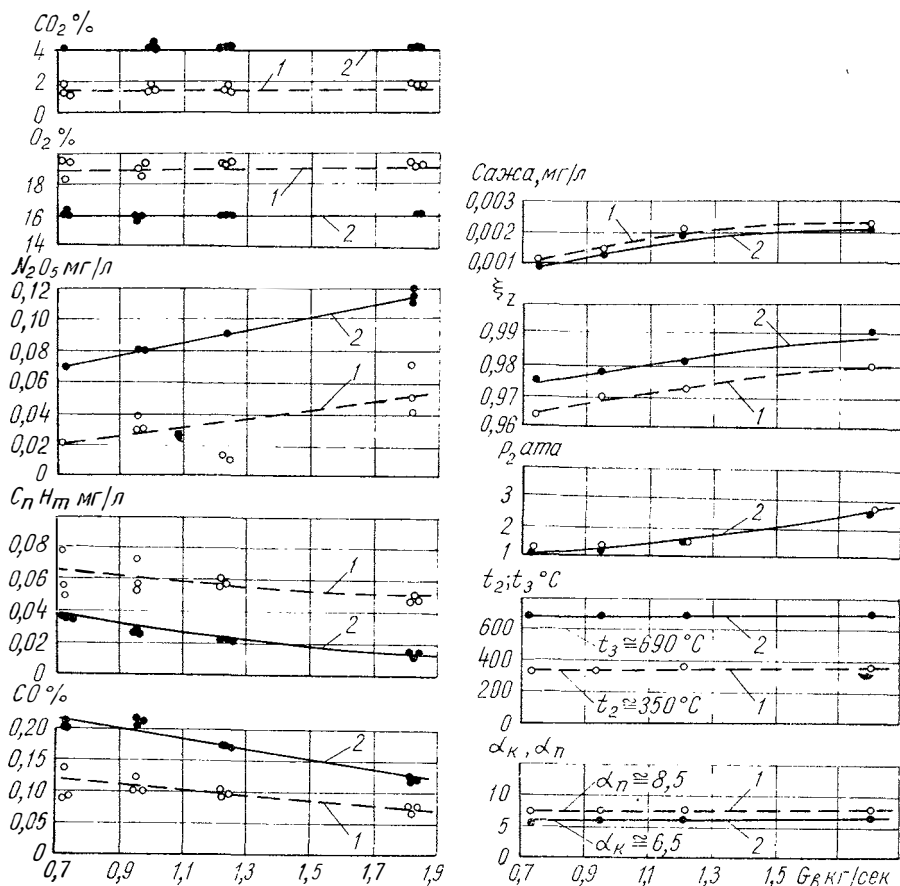
Рис. 1. Характеристики изменения состава продуктов сгорания на выходе из подогревателя и камеры в зависимости от расхода воздуха на модельных режимах ее работы:
