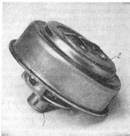
Фиг. 6. Термостат ТС-101 с твердым наполнителем для двигателей ЗИЛ: 1 — термосилового датчик; 2 — поворотная заслонка.
