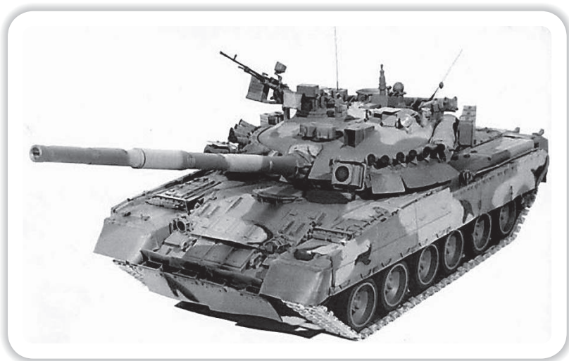
T-80 — первый в мире серийный танк с газотурбинным двигателем
