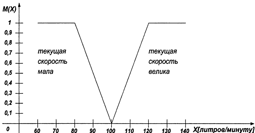
Рисунок 3.2.5. Функции принадлежности термов «скорость подачи воды мала» и «скорость подачи воды велика»
