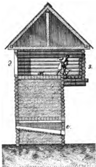
Черт. 33. Разрѣзъ деревянной крѣпостной стѣны. (По Ласковскому).
