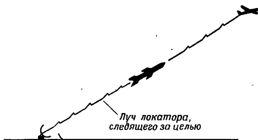
Фиг. 61. Система наведения по радиолучу.
