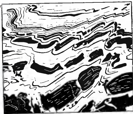
Рис. 117. Геологический профиль, показывающий две стадии разнотипных деформаций: образование складок и надвигов в обстановке горизонтального сжатия и позже — образование нормальных сбросов в условиях горизонтального растяжения. Скалистые горы, США (по А. Ирдли)
