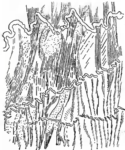
Рис. 89. Развитие и перестройка кливажа в зависимости от степени и характера деформации модели (рисунок по фотографии):
