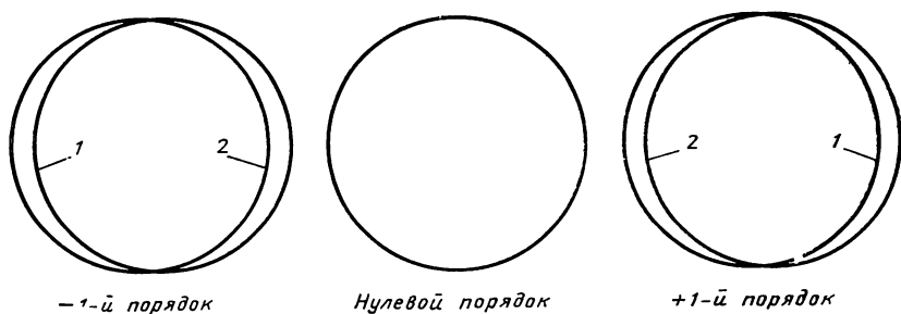
Рис. 4.45. Типичная интерферограмма и дифрагированные апертуры, имеющие место при использовании решетки с двойной частотой:
