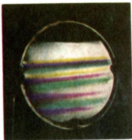
Рис. IV. Интерференция при отражении белого света тонкой мыльной пленкой. Пленка заполняет круглую рамку. Снимок сделан вскоре после стекания пленки до такой степени, что в верхней части ее толщина стала меньше четверти длины самой короткой волны видимого света.
