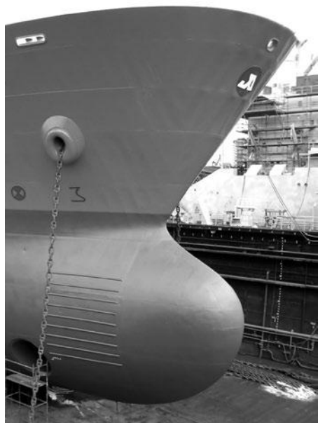
Фотография бульба (слева) и принципиальная схема его работы (справа)
