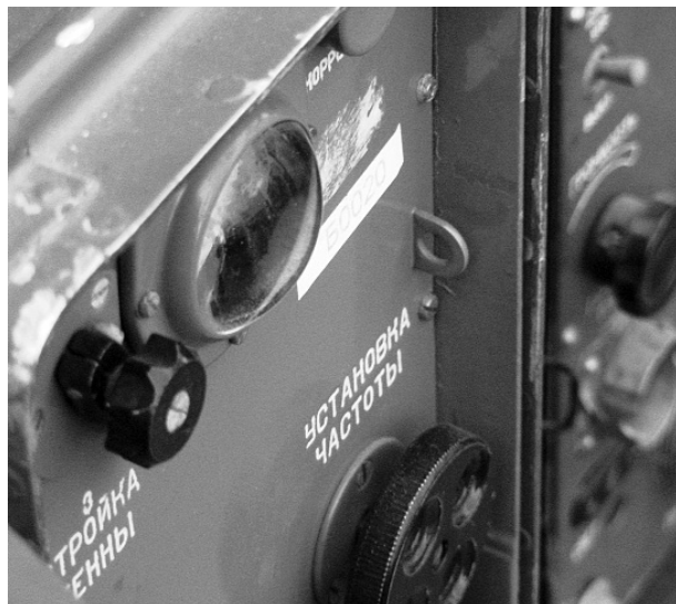
Линза на передней панели радиостанции, чтобы легче читалась шкала
