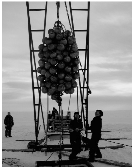
Работы на байкальском нейтринном детекторе. Буй демонтирован – доступ к электронике и оптическим модулям гирлянды открыт
