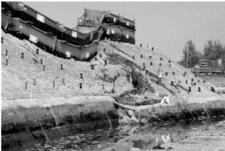
Эксперимент по прорыву «умной» дамбы в Нивесхансе
