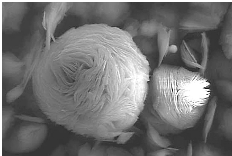
Положие на розы структуры гидроксида магния получены многократным свертыванием тончайших слоев
