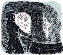
Закалка — самый древний способ улучшения свойств стали.
