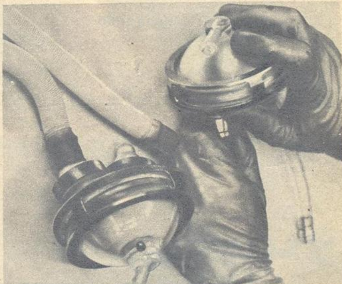
Искусственные желудочки сердца. В опытах на животных эти аппараты помогают обеспечить кровообращение при остром нарушении сократительной способности сердца.
