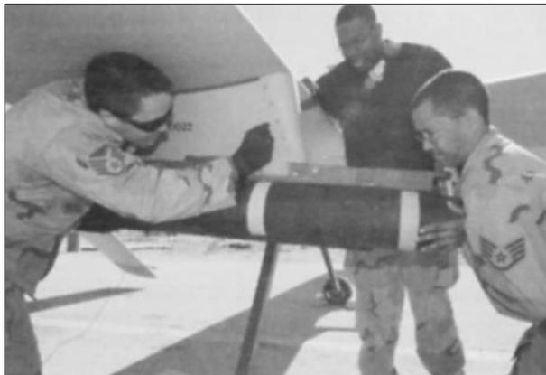
Авиаспециалисты устанавливают управляемую ракету AGM-114 «Хеллфайр-2» класса «воздух – земля» на БЛА RQ-9 «Предатор-В»
