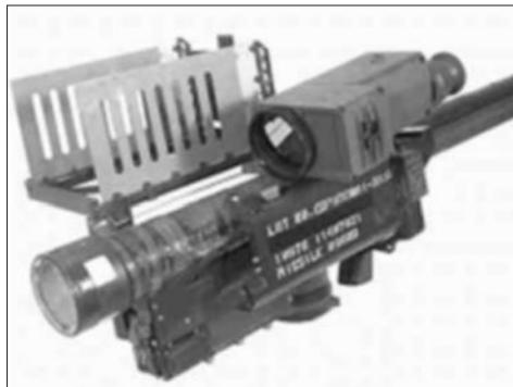
Рис. 6. ПЗРК «Стингер» с тепловизионным прибором WASP
