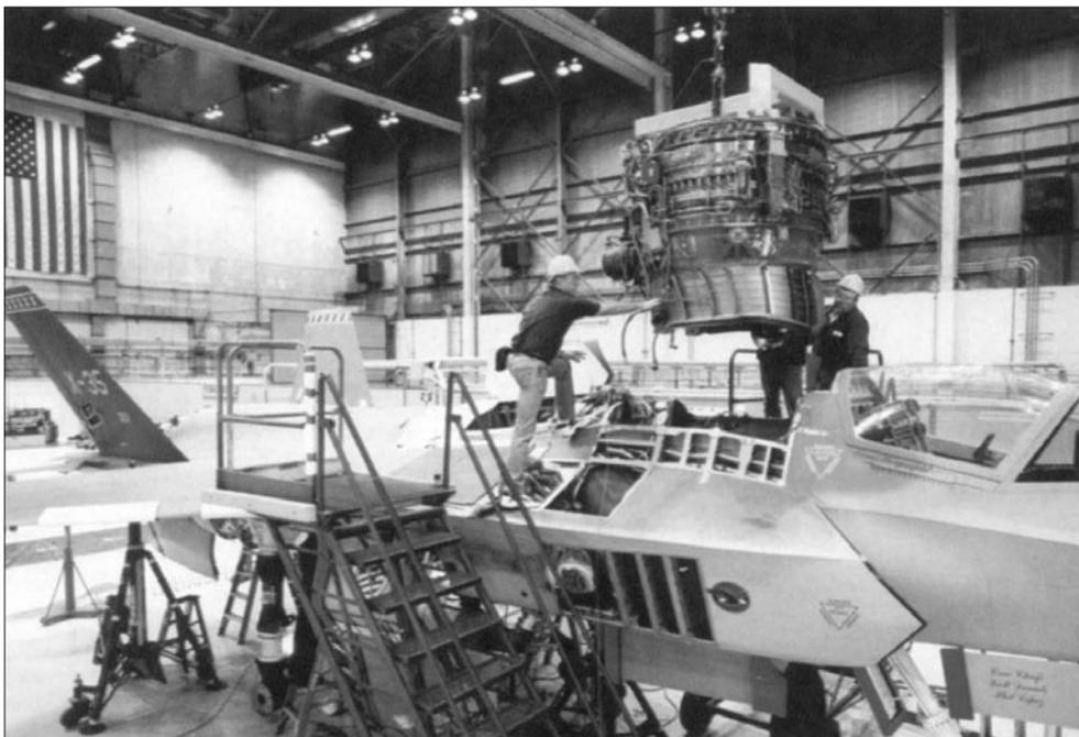
Установка подъемного вентилятора на самолет F-35С в монтажном цехе компании «Локхид-Мартин» на этапе демонстрации концепции
