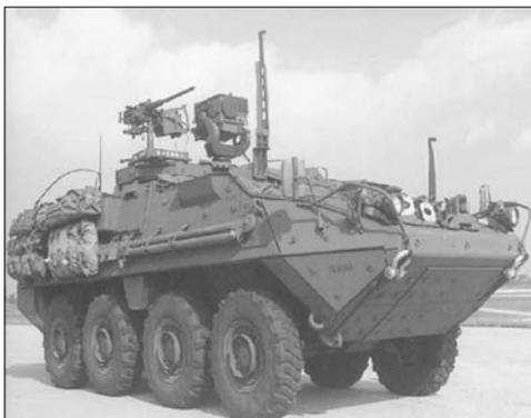
Боевая разведывательная машина «Страйкер», на крыше которой смонтирована электронная разведывательная аппаратура (на корпусе навешены дополнительные броневые листы)
