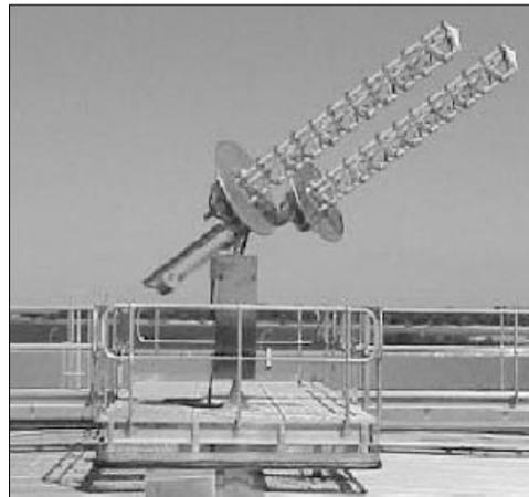
Рис. 4. Станция спутниковой связи RT-1828(P)/G:
