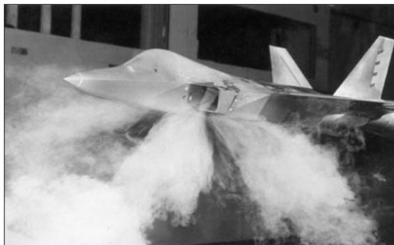
Исследование воздушного тракта двигателя в аэродинамической трубе
