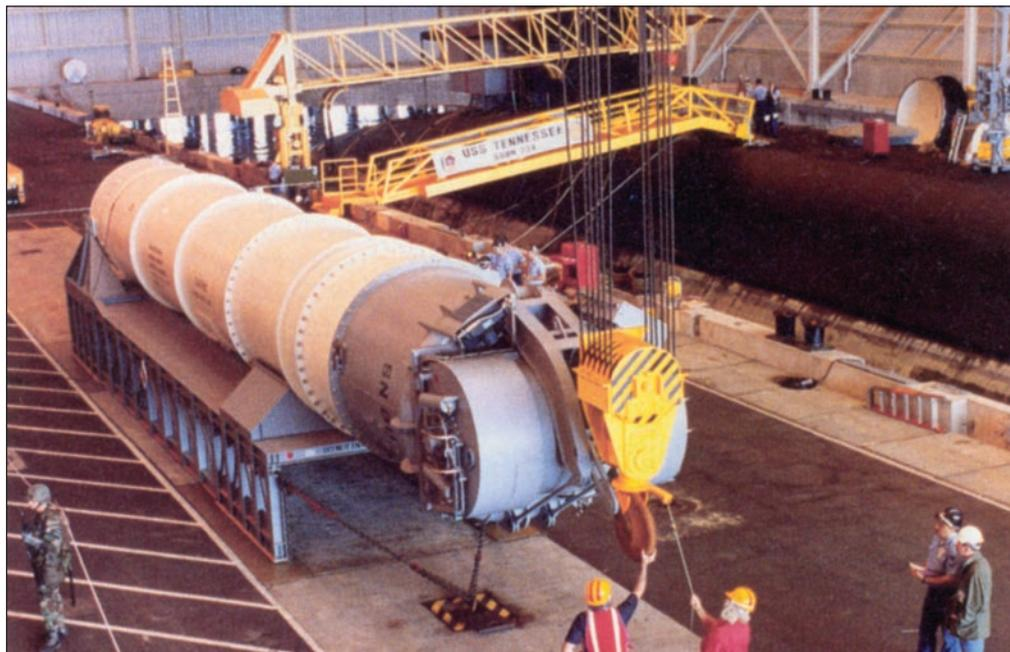
Баллистическая ракета «Трайидент» в контейнере доставлена на причал, после чего ее с помощью кран-балки перегружают на ПЛАРБ
