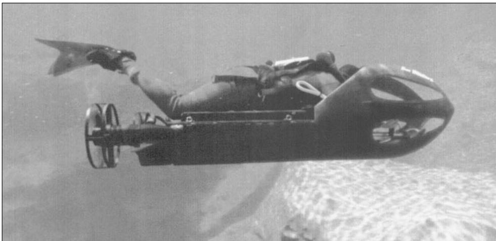
Буксировщик «Sea Shadow» фирмы «Антеон» обеспечивает транспортировку одного-двух водолазов на дальность до 5 миль
