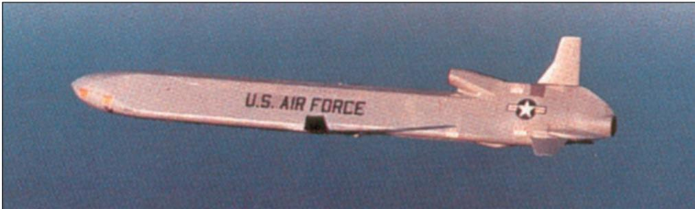
Стартовая масса 1 430 кг; ядерная боевая часть W80-1 с переключением мощности; максимальная дальность стрельбы 2 600 км; скорость полета 208-236 м/с; система управления автономная (инерциальная с коррекцией по контуру рельефа местности с использованием корреляционной системы TERCOM), принята на вооружение в 1981 году.
