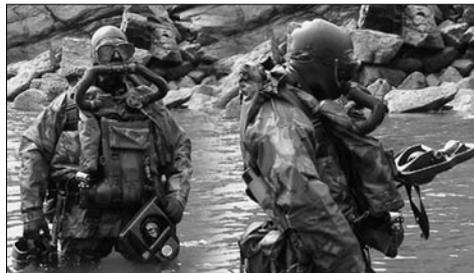
ИДА типа «Shadow Excursion» позволяют водолазам работать на глубине до 42 м
