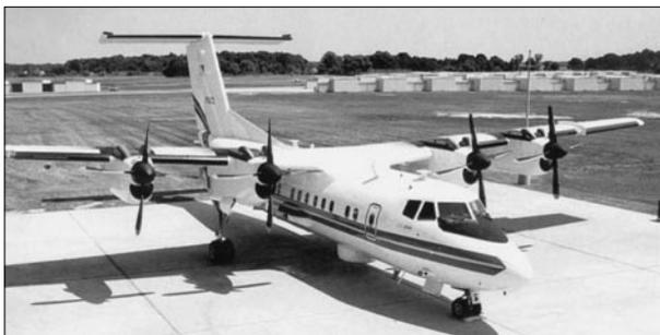
Самолет RC-7B, входящий в состав авиационной системы радиоэлектронной разведки ARL-M
