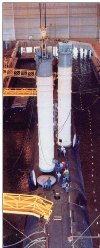
Загрузка БРПЛ «Трайидент» в пусковые шахты подводной лодки «Теннесси» (на рисунках слева направо – все шахты открыты, загрузка первой и второй ракет)
