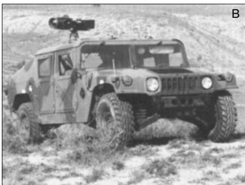
Оптоэлектронный блок состоит из двух камер, работающих в видимом и инфракрасном диапазонах спектра, лазерного дальномера-целеуказателя, электронного блока обработки и передачи сигнала, а также поворотного механизма. Он может устанавливаться как на механических опорах высотой до 40 м, так и на любом транспортном средстве.
