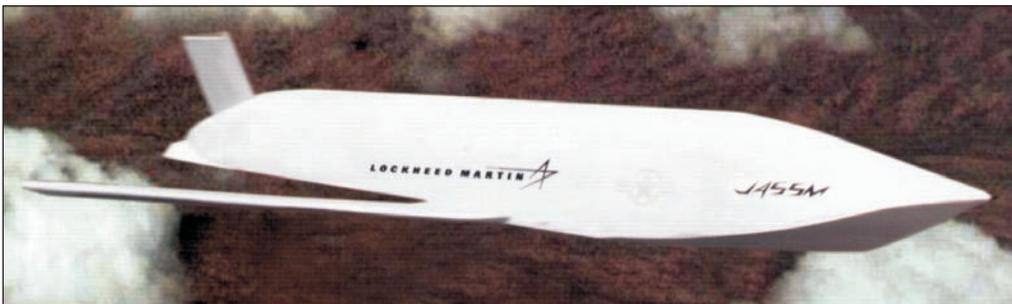
Стартовая масса 1 050 кг, тип боевой части: проникающая (масса 320–340 кг) или кассетная, максимальная дальность стрельбы около 400 км, скорость полета (число  $M = 0,8-0,9$ ), система управления комбинированная (инерциальная с коррекцией по данным КРНС NAVSTAR и тепловизионная ГСН с режимом автоматического распознавания цели), принята на вооружение в 2001 году.
