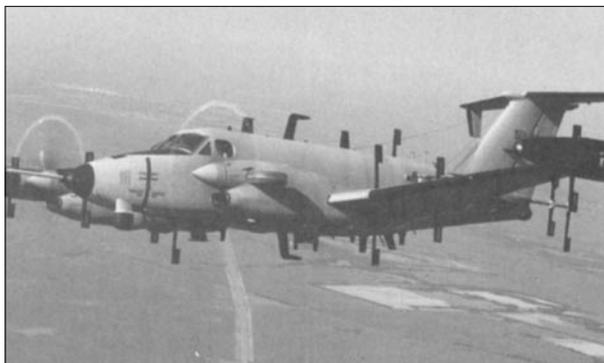
Разведывательный самолет RC-12 – компонент авиационной системы радиоэлектронной разведки «Гардрейл коммон сенсор»
