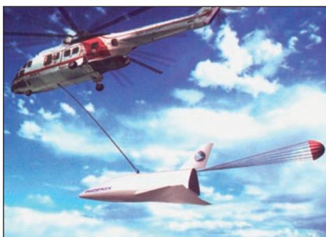
вертолетом на высоту 2 400 м, откуда в автоматическом режиме осуществил снижение и посадку. В ходе 90-секундного планирующего полета была достигнута скорость 450 км/ч. На следующем этапе испытаний предполагается выполнить сброс модели с большей высоты, на которую ее планируется поднять на воздушном шаре. Согласно прогнозам специалистов компании EADS, эксплуатация МТКК начнется в 2015–2020 годах.
