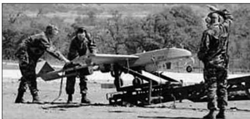
Рис. 4. Беспилотный летательный аппарат «Шэдоу 200»
