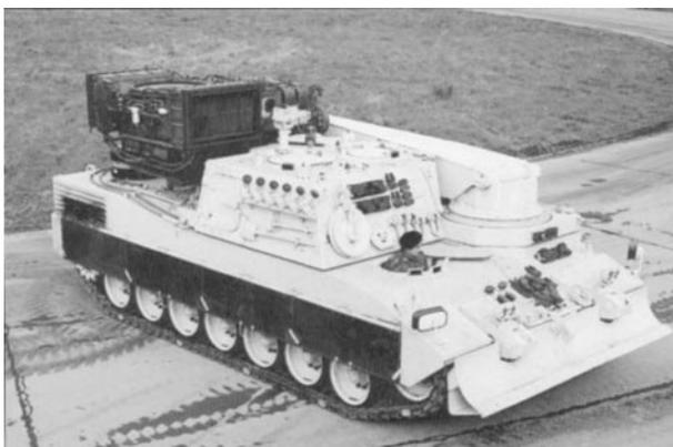
Итальянская БРЭМ OF-40 в походном положении. На грузовой платформе закреплен силовой блок ОБТ
