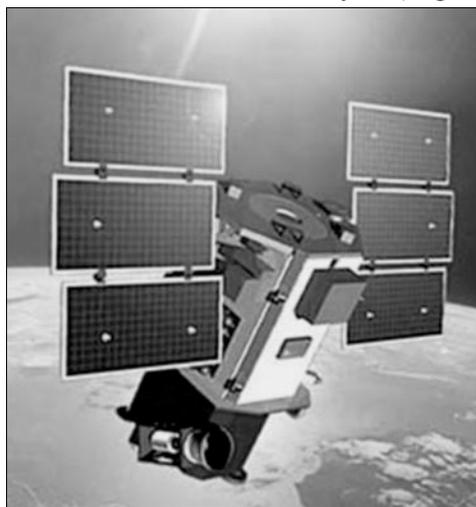
ИСЗ «Квик Бёрд-2» имеет максимальную разрешающую способность 0,61 м
