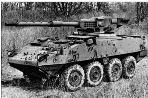
Рис. 3. Боевая машина с тяжелым вооружением LAV-III «Страйкер»
