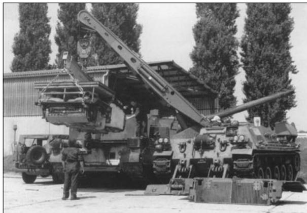
С помощью оборудования БРЭМ AMX-30D производится замена силового блока ОБТ
