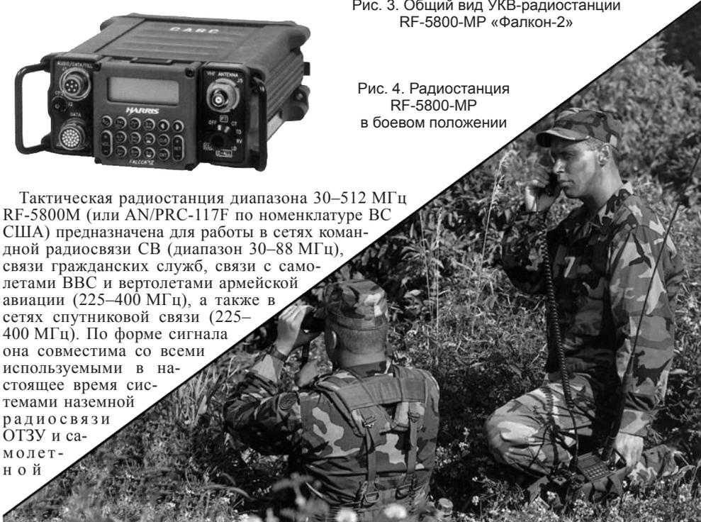
радиосвязи, имеет встроенный модуль приемника системы NAVSTAR. Для сопряжения с оконечной аппаратурой данная станция оборудована интерфейсами RS-232 и -422. Скорость передачи данных в сетях наземной радиосвязи составляет 64 Кбит/с, в сетях спутниковой связи – до 56 Кбит/с, масса без батареи 4,5 кг.
