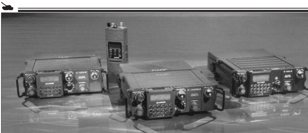
Рис. 2. Общий вид тактических радиостанций RF-5800 «Фалкон-2» американской корпорации «Харрис»
