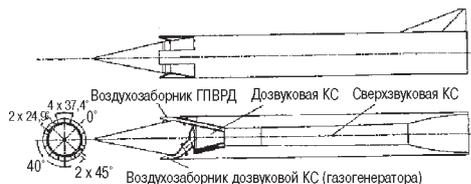
Рис. 3. Компоновка двухрежимного ПВРД DCR
