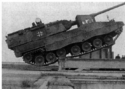
Рис. 2. Преодоление уступа
