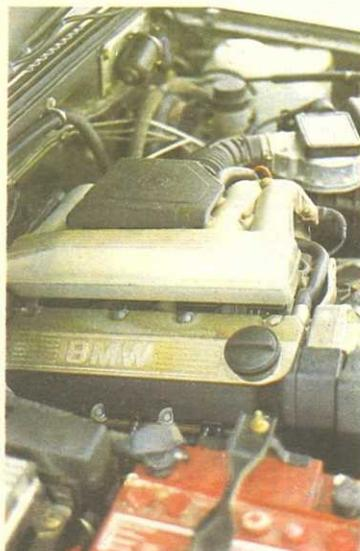
Двигатель немецкой фирмы БМВ, система впрыска топлива — «Бош-Мотроник».
