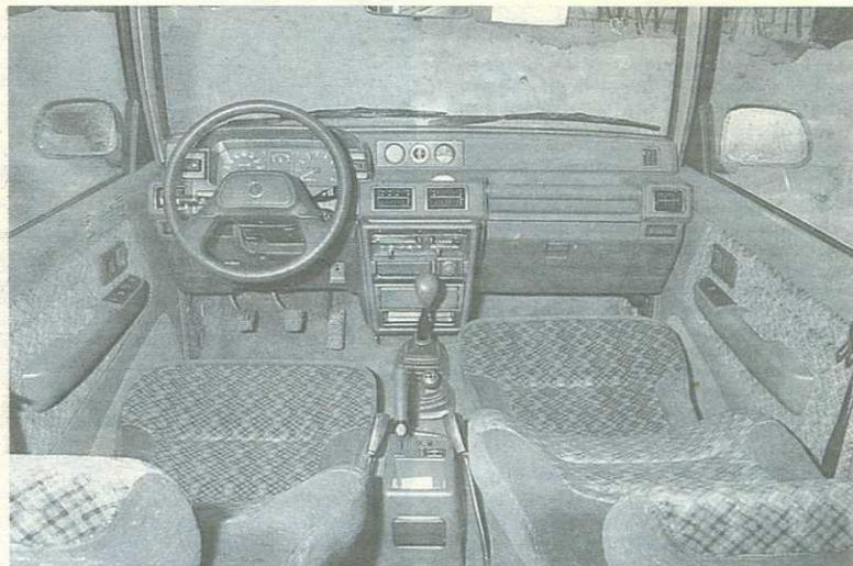
Спинки сидений сейчас опущены. Боковые окна — очень большие. Угол наклона рулевого колеса можно регулировать. На приборной панели минимум клавиш: освещение включается поворотом рычага на рулевой колонке.
