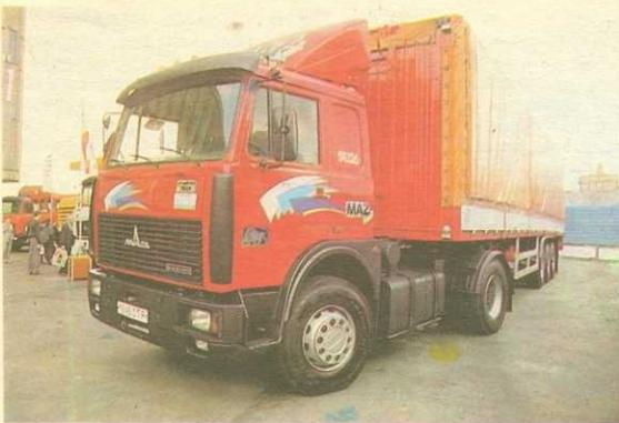
**ОТ МАЗА ОСТАЛАСЬ ЛИШЬ БУКВА «З»** в индексе вполне современной машины — МАЗ-54326, рассчитанной на буксировку полуприцепа МАЗ-9758. У этого тягача — дизель MAN D2866LF05 мощностью 370 л. с./272 кВт, коробка передач
