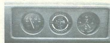
Вольтметр, указатель крена кузова, часы. Дизайн циферблотов — фирменный.
