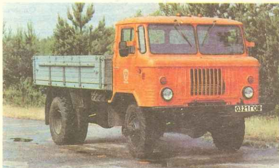
ГАЗ-66-21: увеличена деревянная платформа, усилены элементы — ведущие мосты, рама, рессоры.
