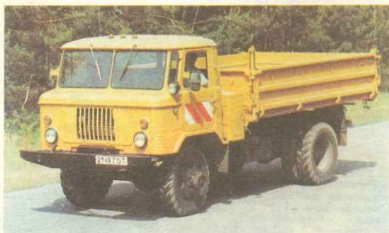
ГАЗ-3531 с самосвальной платформой и гидравлическим подъемным устройством.
