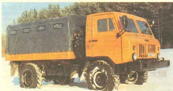
Одни из опытных образцов грузовика на шасси ГАЗ-66 с дизелем воздушного охлаждения.
