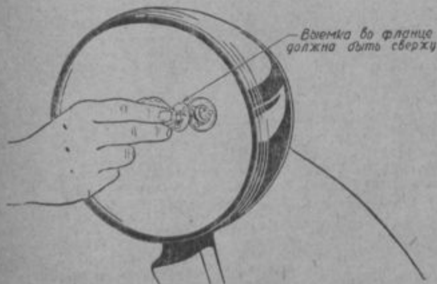
Рис. 2. Установка лампочки в рефлектор
