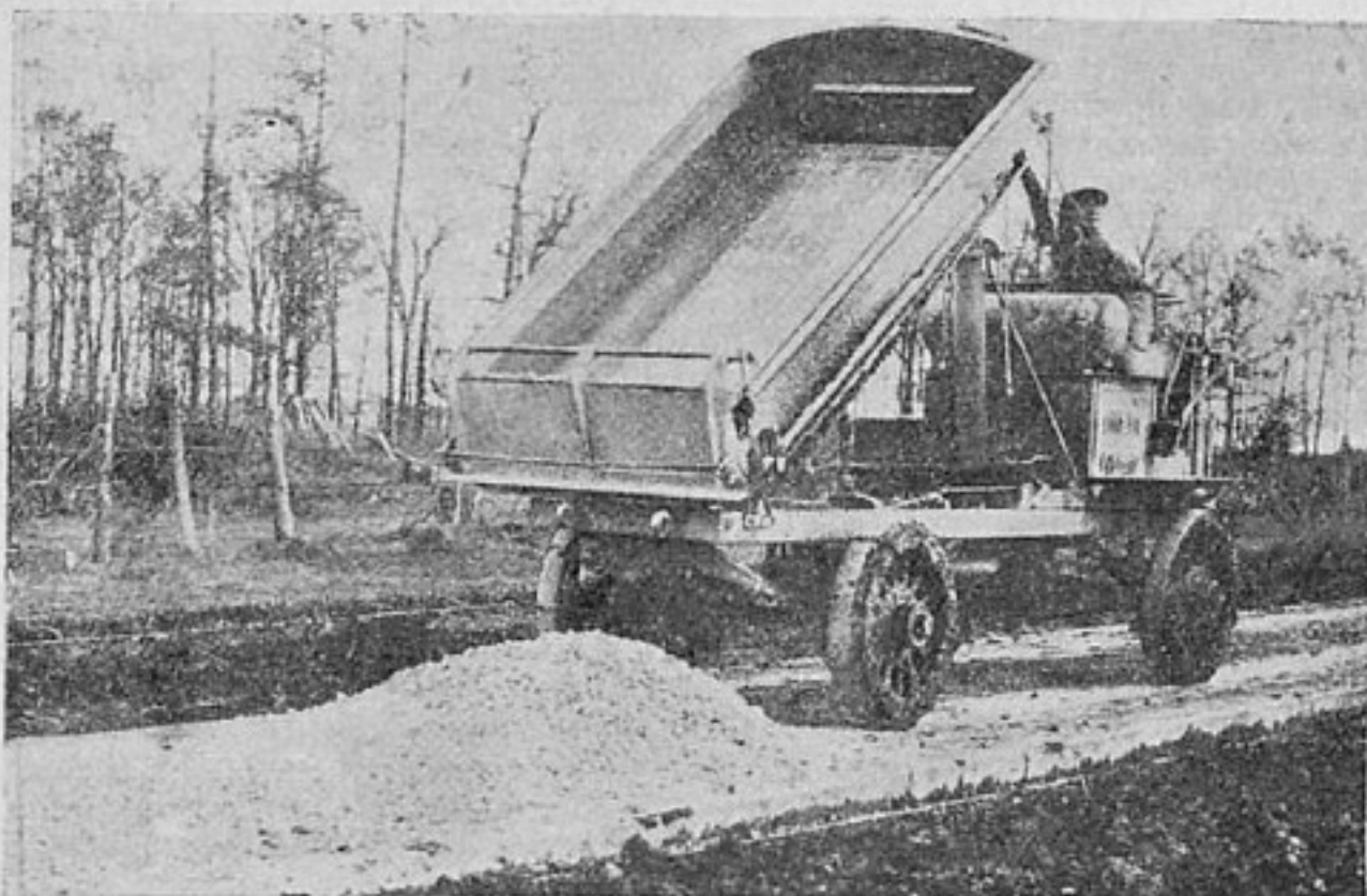
Грузовик с самопрокидывающимся кузовом сыплет строительный материал. Подъем кузова производится механически с сиденья шофера
