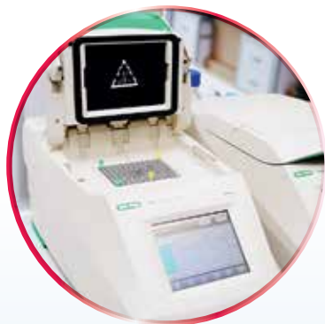
Амплификатор — прибор для проведения ПЦР — реакции, которая нужна для получения фрагментов будущих конструкций и их проверки
