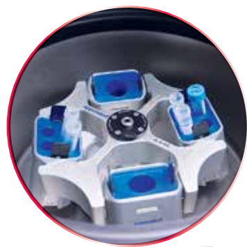
Центрифуга используется для самых разных целей: от выделения клеток крови и растительных клеток до выделения белков и ДНК
