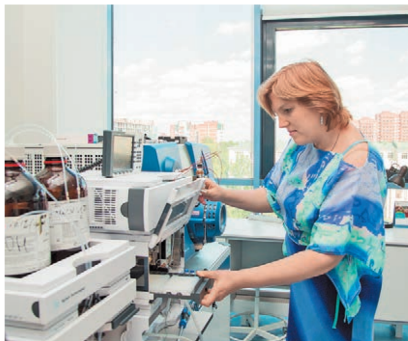
С помощью тройного масс-спектрометра с ионной ловушкой (стоимостью около 1 млн долларов) проводят фармакокинетические исследования лекарственных препаратов, определение метаболитов в плазме крови животных и человека и другие высокотехнологичные исследования. Прибор находится в биоаналитической части, за которую отвечает заместитель заведующего лабораторией Наталья Галкина. Здесь же проводят исследования «на столе» новых синтезированных соединений. Например, моделируется высвобождение лекарственных средств в желудочно-кишечном тракте в условиях in vitro . Если соединения не «разваливаются», то такие вещества уже отправляются на доклинические исследования, которые проводятся на животных.
