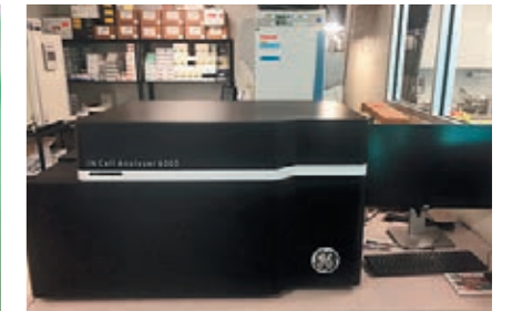
Прибор InCell6000 — микроскоп, совмещенный с чувствительным фотоаппаратом и обрабатывающей программой
