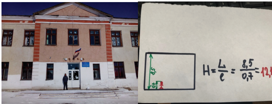
Рис. 5. Фрагмент опытно-экспериментальной части. Метод измерения высоты с помощью фотографии
