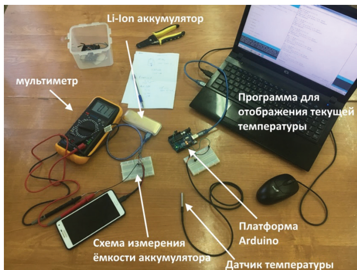
Рис. 1. Внешний вид стенда для определения текущей температуры и емкости аккумулятора
