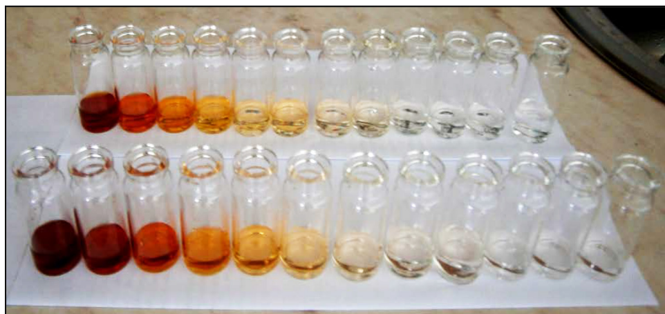
Рис. 2. Внешний вид флаконов 2 серий после 11-кратного разведения исходного раствора соединения железа (III) до постановки реакции
