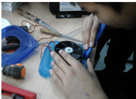
Рис. 2. Вырезаем в крышке контейнера отверстие для поступления воздуха в контейнер, с помощью канцелярского ножа
