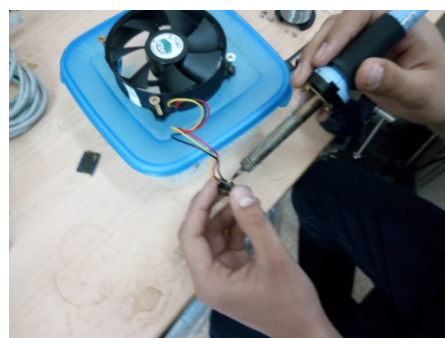
Рис. 4. Оголяем провода кулера с помощью плоскогубцев, дальше припаиваем с помощью паяльника провода кулера к штекеру и подключаем к зарядному устройству ноутбука
