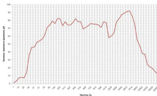
Рис. 4. Исследование АЧХ наушника Sennheizer MX500
