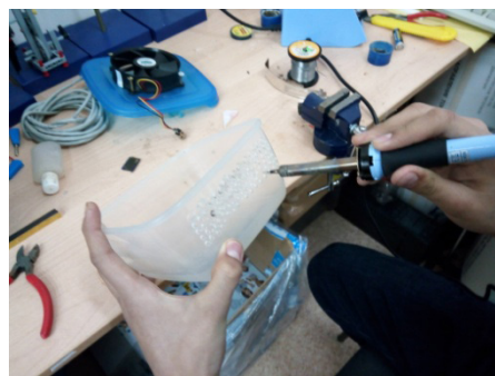
Рис. 3. Расплавляем в контейнере с помощью паяльника отверстия для подачи воздуха в наружу
