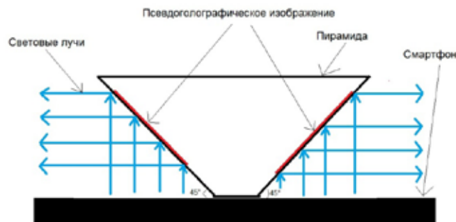
Рис. 2. Ход лучей в голографической пирамиде
