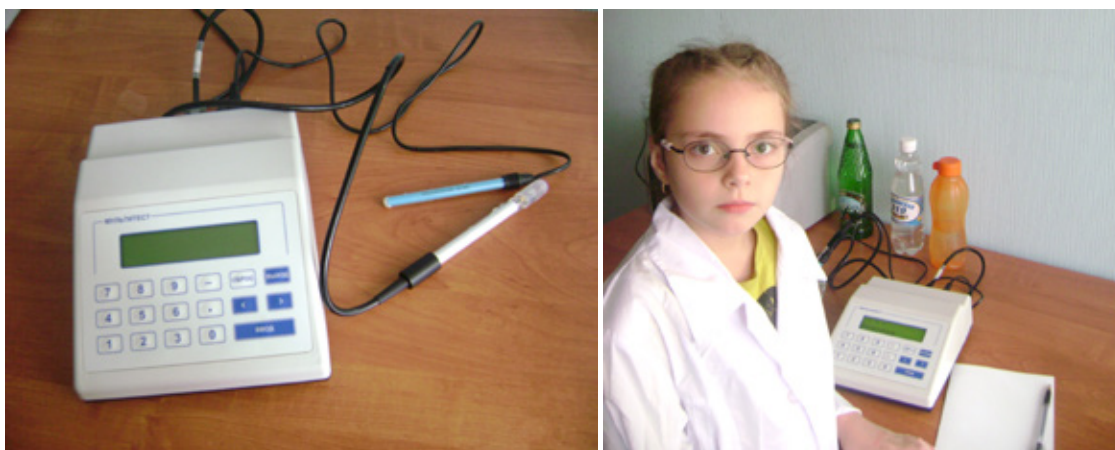
Рис. 1. Внешний вид кондуктометра Мультитест КСЛ-101 и процесс измерений
