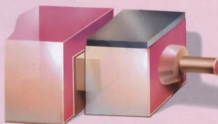
В исходном состоянии пластинка пьезоэлемента выпрямлена
