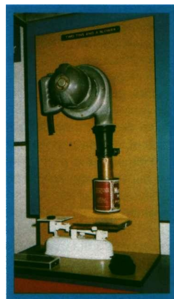
Лаборатория К. Кокерелла: кран со сжатым воздухом, консервная банка и кухонные весы.
