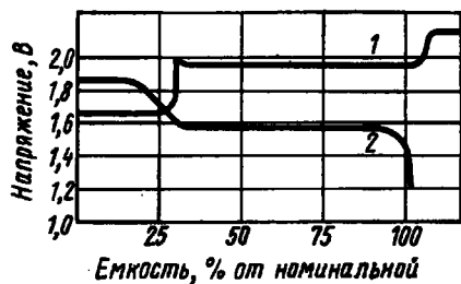
Рис. 10.1. Изменение напряжений серебряно-цинкового аккумулятора при заряде (1) и разряде (2) током 0,1 C_{ном}
