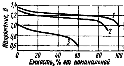
Рис. 3.3. Разрядные характеристики щелочного никель-кадмиевого аккумулятора:
