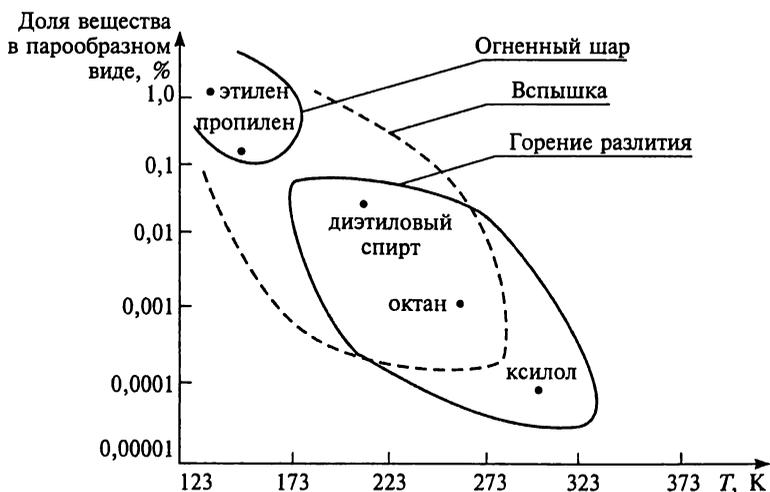
Рис. 4.2. Зависимость характеристик пожара от температуры кипения вещества
