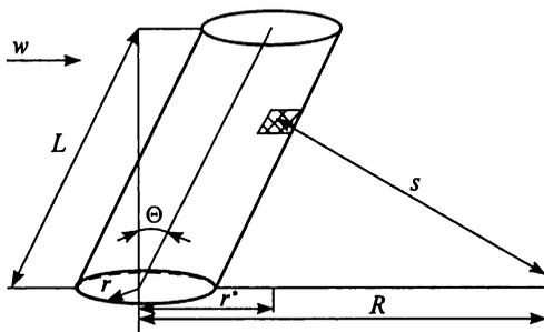
Рис. 4.5. Расчетная схема пожара разлива:
