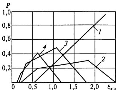
Рис. 7.1. Зависимость вероятности разрушения ОПФ  $P$  от показателя устойчивости оборудования  $\xi_{т.о.}$ :
