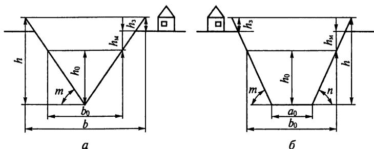
Рис. 3.1. Расчетная схема сечения реки:
