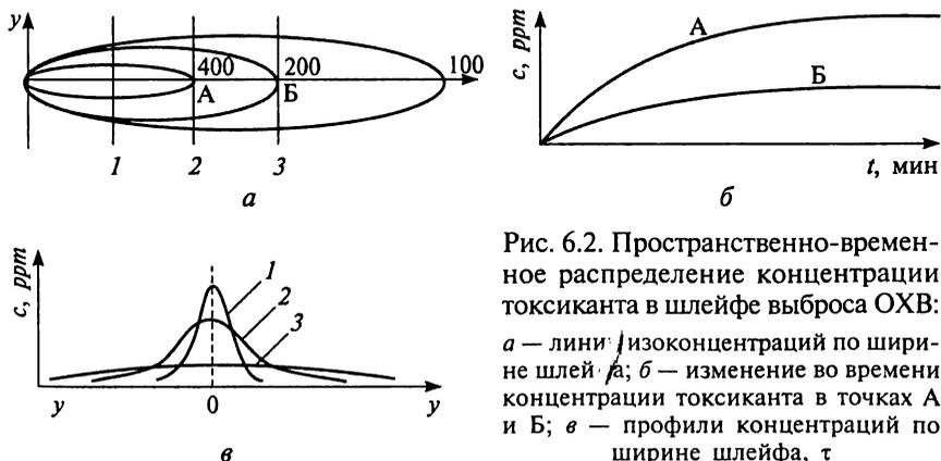
Рис. 6.2. Пространственно-временное распределение концентрации токсиканта в шлейфе выброса ОХВ: *a* — линии /изоконцентраций по ширине шлейфа; *б* — изменение во времени концентрации токсиканта в точках А и Б; *в* — профили концентраций по ширине шлейфа,  $\tau$
