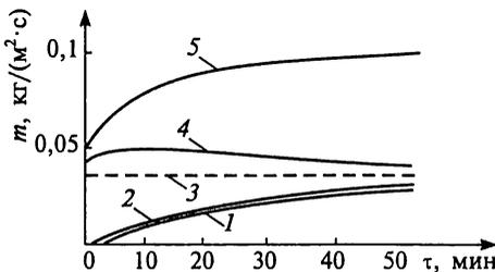
Рис. 4.3. Растекание и испарение сжиженного газа углеводородного состава ( $R_k = 750$  м) при истечении из трубопровода с расходом 500 кг/с:
