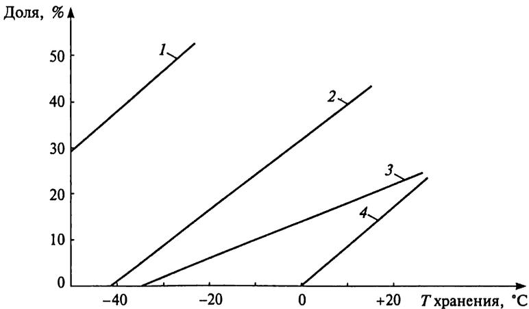
Рис. 4.1. Доля мгновенно испарившейся в адиабатическом режиме жидкости:
